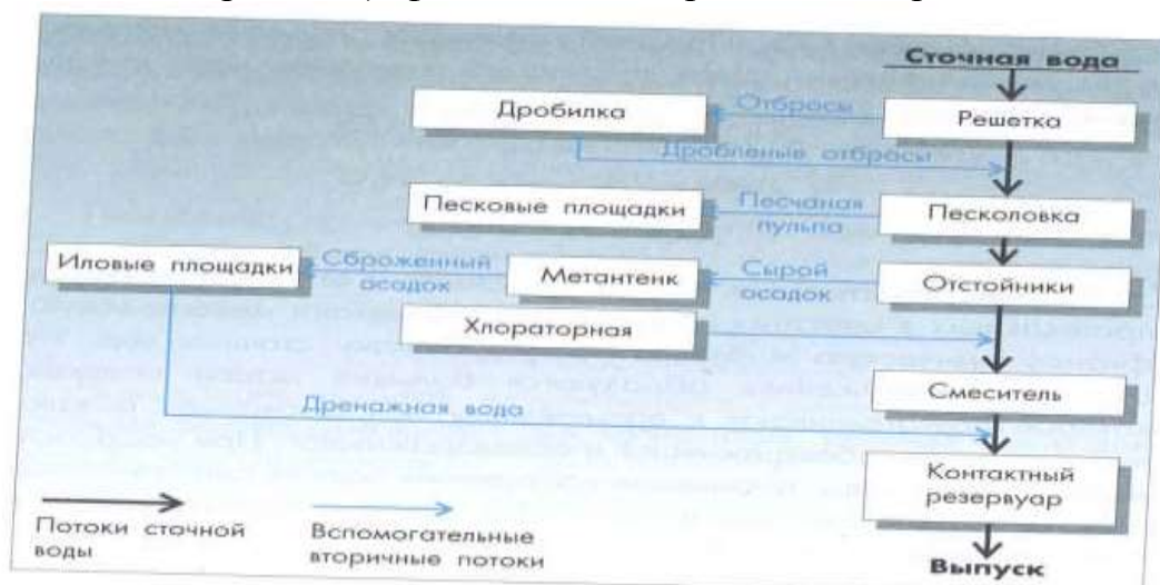
Рис. 7. Технологическая схема очистной станции с механической очисткой сточных вод.
